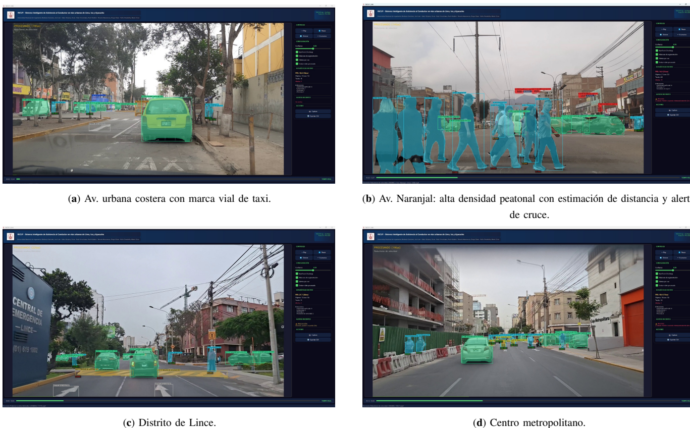
Figura 8. Aplicación RICUY en operación sobre secuencias de validación de Lima, mostrando máscaras de segmentación, identificadores de seguimiento, distancia monocular estimada y alertas activas (RTX 3050).
