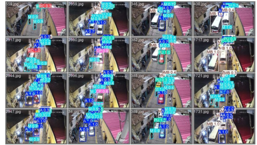
Fig. 32. Batch 1 validación — predicciones. Detección robusta nocturna con confianzas 0,7–1,0.
