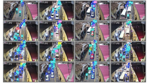
Fig. 31. Batch 1 validación — ground truth. Escenas nocturnas con deslumbramiento de faros.
