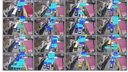
Fig. 30. Batch 0 validación — predicciones. A, M y MB con confianzas \geq 0,9 .
