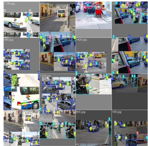
Fig. 12. Muestra de imágenes del batch de entrenamiento con sus anotaciones: clases a, m, mb, pu, mt, cp, cg y placa sobre escenas urbanas diurnas y nocturnas.
