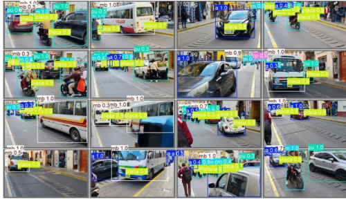
Fig. 18. Batch de validación: predicciones del modelo con confianzas. Las detecciones de placa (amarillo) se envían al módulo ALPR para el reconocimiento de caracteres.
